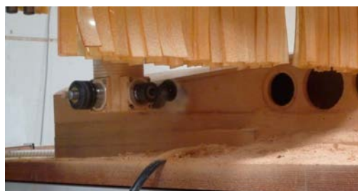
Einfräsen der Lautsprecherausschnitte
