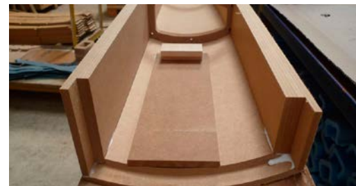
Verkleben mit Vorder- und Rückseite
