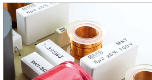
Frequenzweiche mit hochwertigen Bauelementen
