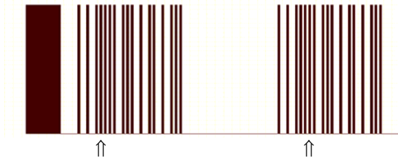
Erstes Impulspaket mit Startbits Wiederholung
